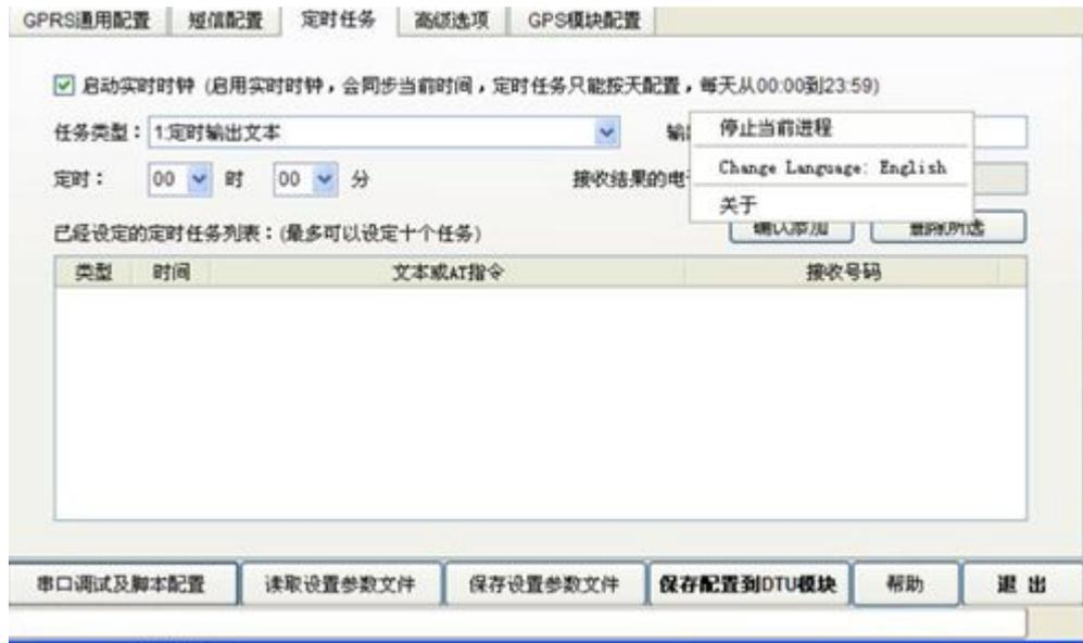
如上图停止当前进程选项可以帮助用户立即中止当前程序进程，例如：用户点击DTU进入配置模式按钮后，DTU启动后进入配置模式，用户可以通过停止当前进程来中止此进程。
