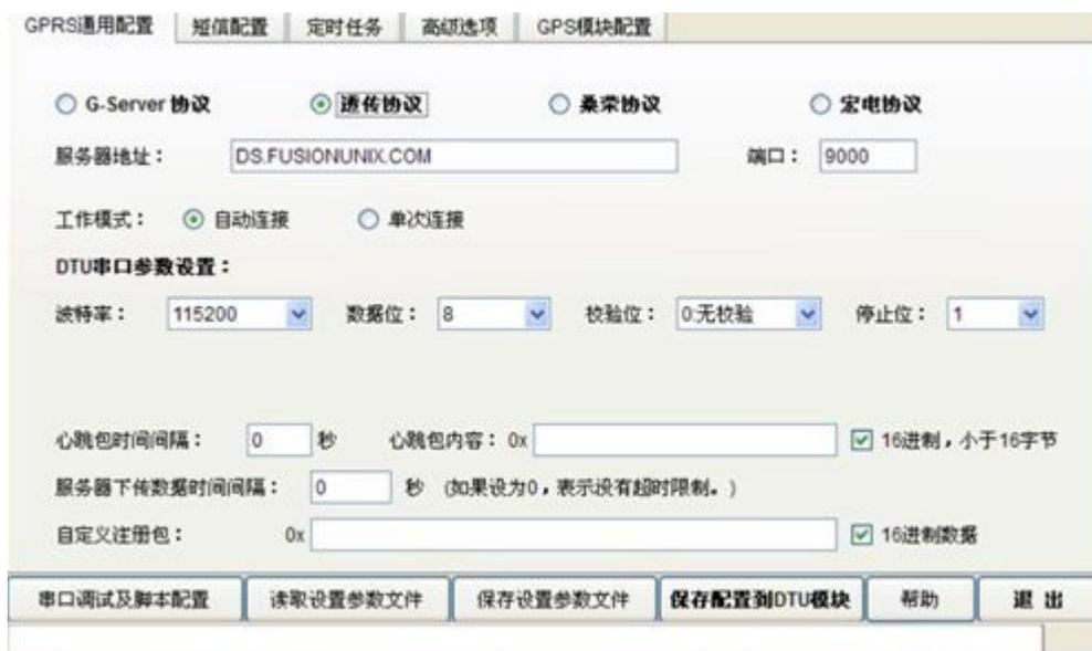
在如上图的界面中，用户可以设置心跳包的内容(ASCII码或 16进制数据)和时间间隔，心跳包是为了在 GPRS通信空闲时避免运营商切断连接而定时发送的数据包。
