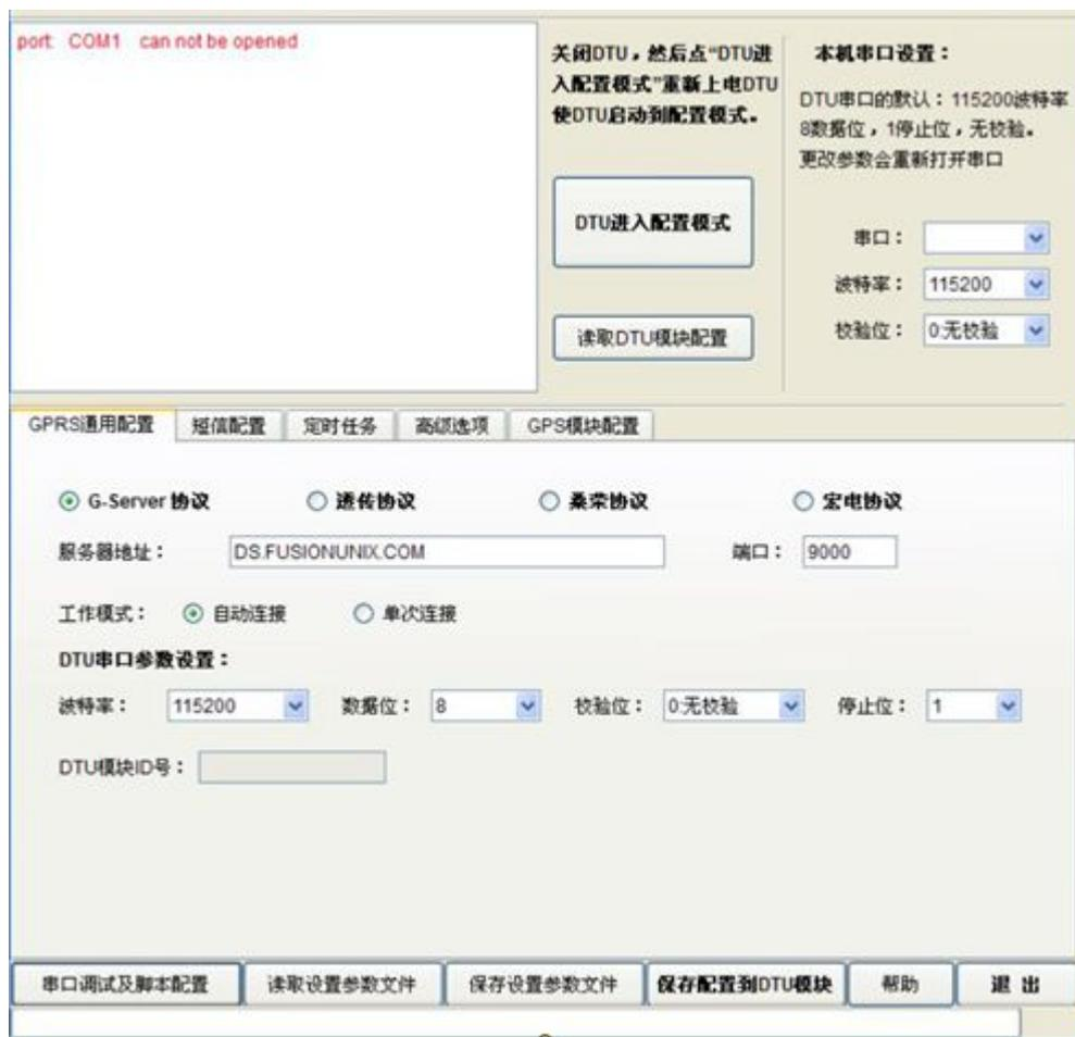
配置时 DTU 最好不插 SIM 卡（插拔SIM卡要断电），防止 DTU 进入自动连接模式。
